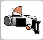
Für eine Rohrkürzung benützen sie eine feine Säge um einen rechtwinkligen Schnitt zu erreichen.
