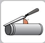
Entgräten und schleifen sie die Schnittstellen in einem Winkel von 15°; die Oberfläche des geschliffenen Stücks sollte vollkommen glatt sein um eine Beschädigung der Dichtung in der Steckmuffe des Anschlussrohres zu vermeiden.
