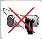
Die Enden der Verbindungselemente (Steckmuffen) sollten niemals verkürzt werden, da in diesem Fall die Verbindung unzuverlässig wird.
