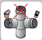
Überprüfen Sie stets das Innere des Rohransatzes (Steckmuffe mit Dichtung), die Dichtung und das neue Rohrrende und verwenden Sie für die Verbindungen von Argo im Zubehör geliefertes und geeignetes Gleitmittel. Benutzen Sie keinesfalls Mineral- oder Schmieröl.
